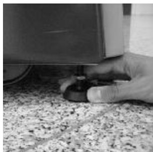
Fare scendere i piedini della macchina fino ad assicurarsi che le ruote siano sollevate da terra
