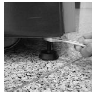
Bloccare i piedini della macchina avvitando i dadi
