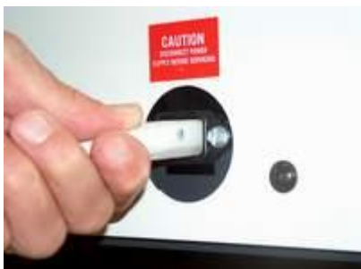
Collegare il cavo di alimentazione alla macchina SO100 per poter aprire la portina
