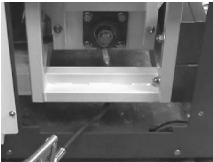
figuur 14, smeerpunt (links en rechts) flenslager
