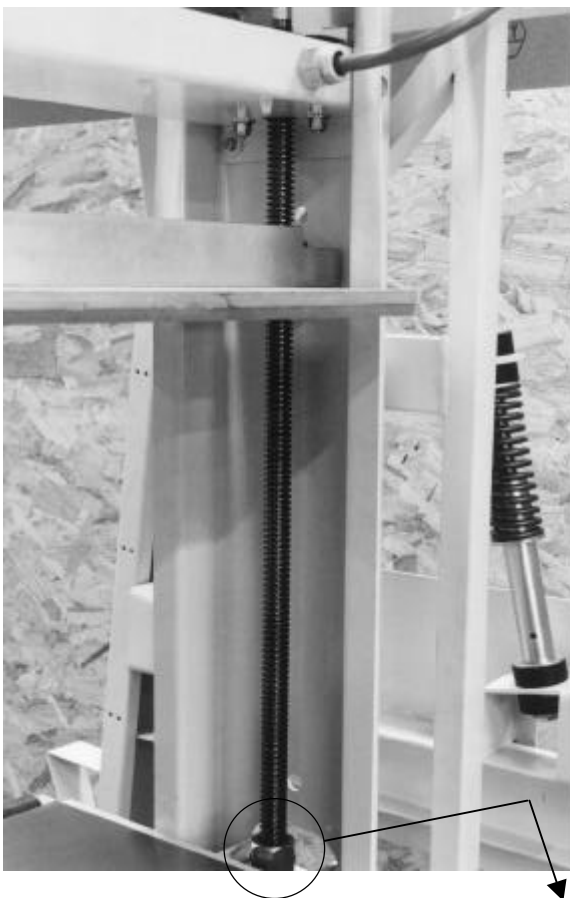
figuur 11, smeerpunten draadspindels (2x) en taatslagers (2x)
